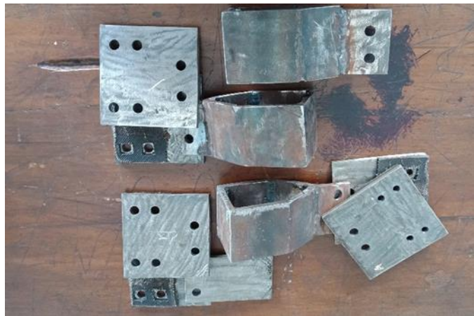
Gambar 30. Pelat penjepit spesimen (Dokumentasi Pribadi)
