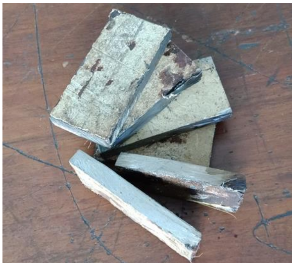
Gambar 29. Pelat pembatas ketebalan (5 mm) (Dokumentasi Pribadi)
