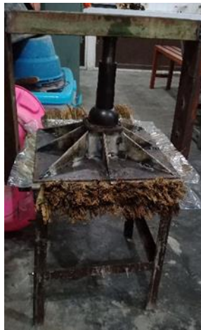
Gambar 36. Pengepressan lamina serat rumput payung (Dokumentasi Pribadi)
