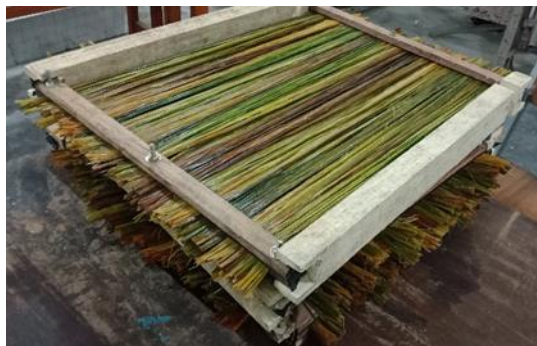
Gambar 35. Penyusunan serat pada kayu penjepit (Dokumentasi Pribadi)
