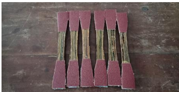
Gambar 39. Spesimen yang siap siap diuji tarik (Dokumentasi Pribadi)
